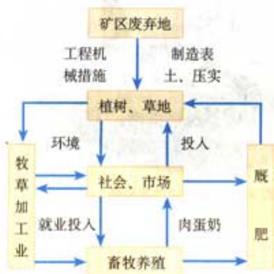
图5-16 矿区生态恢复工程流程图
